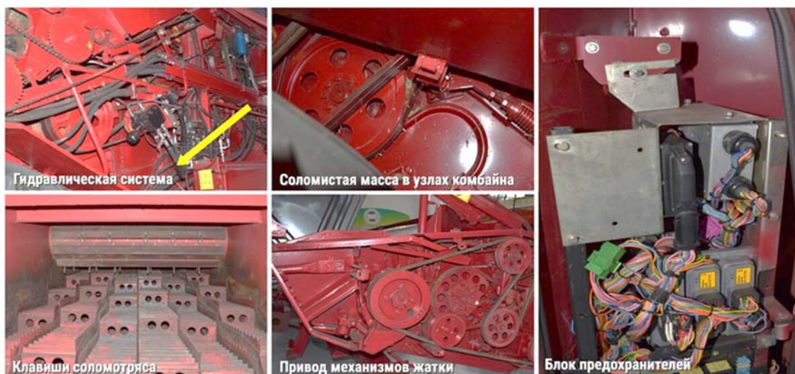
Рисунок 6 – Самые пожароопасные узлы зерноуборочного комбайна «Палессе GS14»
